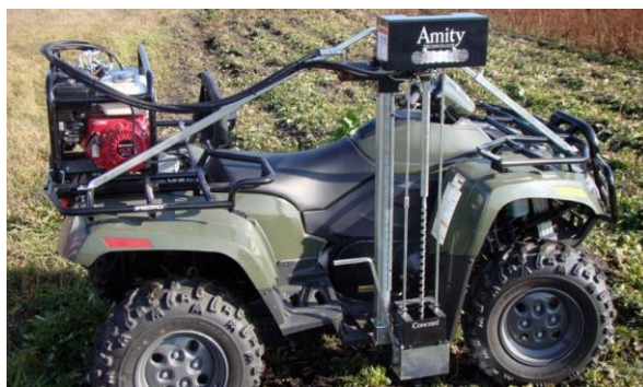
Рисунок 1 – Установленный на квадроцикл автоматический гидравлический пробоотборник грунта (автор фото В. А. Монастырский)
