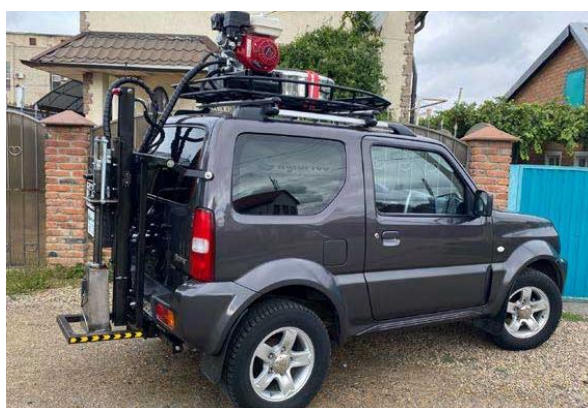
Рисунок 2 – Автоматический пенетрометр с пробоотборником почвы (автор фото В. А. Монастырский)
