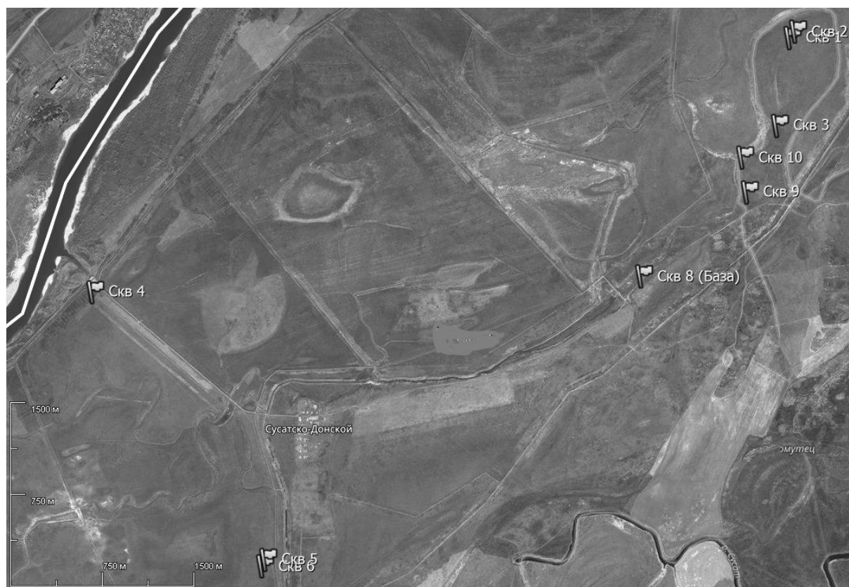
Рисунок 1 – План расположения скважин на полях обследуемого участка
